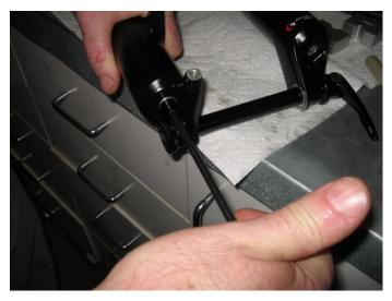
Remove the air side bottom bolt.
