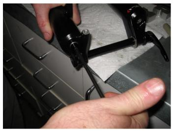
Remove the air side bottom bolt.
